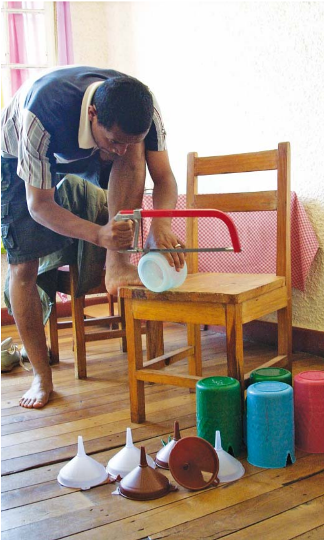
Confection des pluviomètres par l'ingénieur chargé des études hydrologiques
