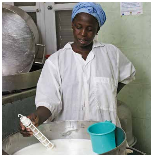
Surveillance de la température pendant la pasteurisation, Sénégal © F. Boyer
